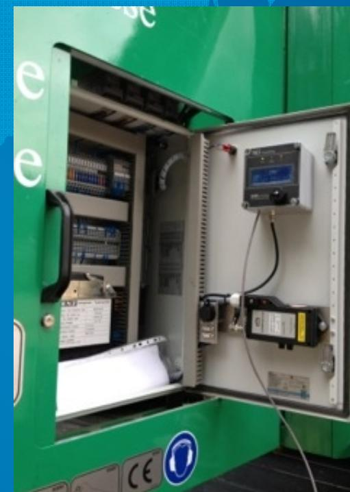
I dati possono essere letti direttamente dal display LCD della centralina, scaricati tramite chiavetta USB o trasmessi via remoto tramite localizzatore satellitare
